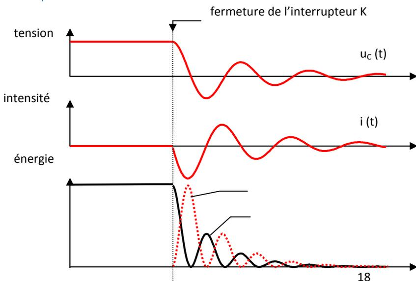
Au cours des oscillations libres, il y a échange d'énergie entre la bobine et le condensateur
