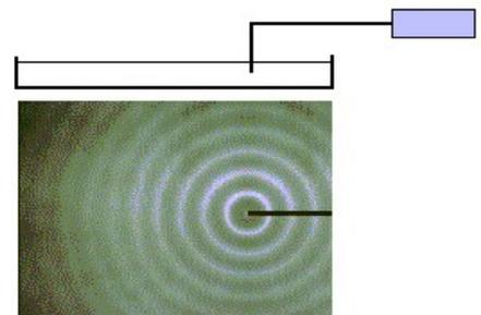
Objectifs: Réaliser l'enregistrement vidéo d'une onde périodique progressive; mesurer la fréquence  $f$  et la longueur d'onde  $\lambda$  de l'onde périodique ; en déduire la célérité  $v$  de l'onde.
