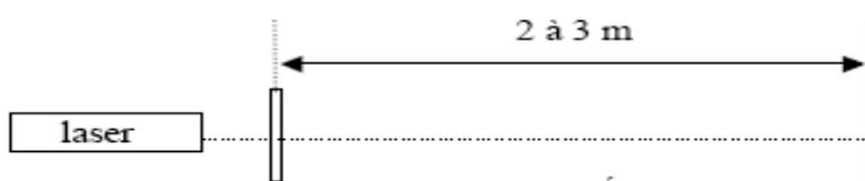
→ Placer l'écran loin du laser. Placer la fente sur le trajet du faisceau laser.
